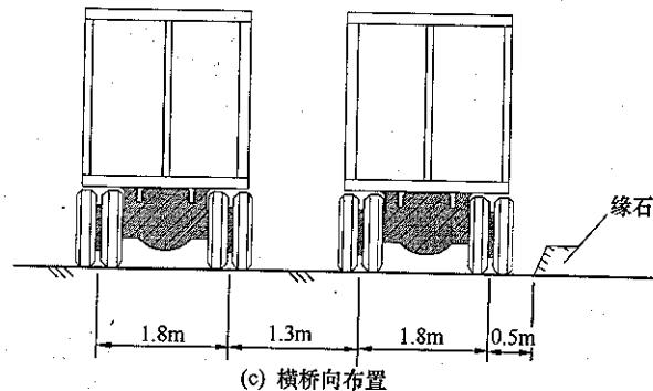
图 10.0.2-2 城一A 级车辆荷载立面、平面、横桥向布置
